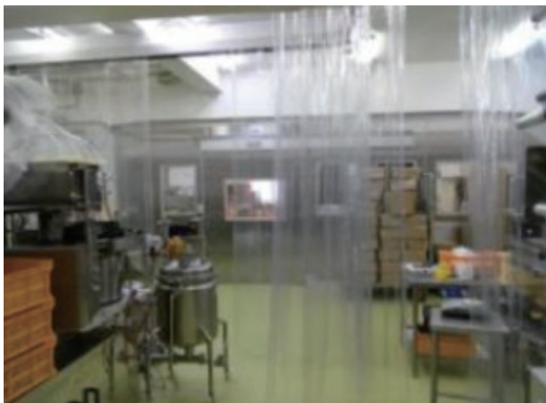
ビニールシートによる区画設置例
